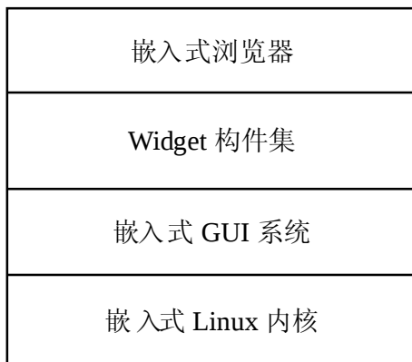
图 11.21 基于 MicroWindows 的嵌入式 Linux 系统组成
