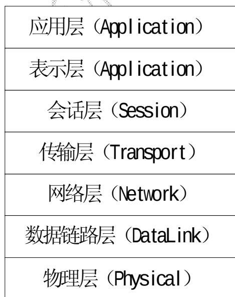
图 11.23 OSI 7 层协议示意图
